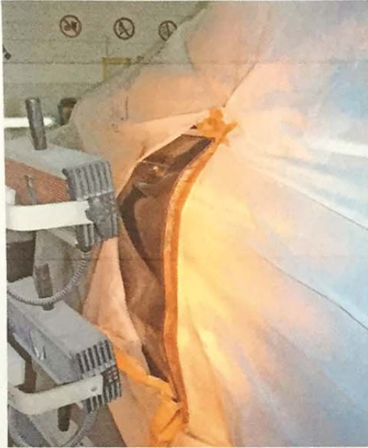
Spot-Repair an der Fahrertür eines Leasingfahrzeugs – Einsatz von Infrarotstrahlern zur Beschleunigung des Trocknungsprozesses.
